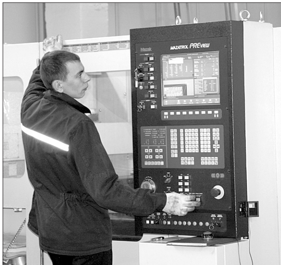
Пульт управления японским лазерным комплексом MAZAK для резки металла.
